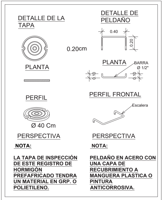
DETALLE ARMADO REGISTRO
